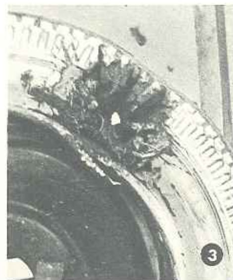
in basso da proiettili di fucile, in alto da proiettili di un cannone anticarro calibro 20 mm; la fig. 3 mostra l'effetto prodotto dallo scoppio di una granata da 20 mm di calibro.
