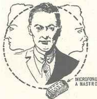
Direzionalità del microfono a nastro.
